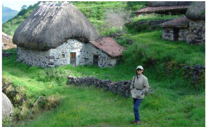
Pili Galiana ante una palloza. Se puede ver con total claridad la planta rectangular de la cuadra, cubierta con teito, y el reducido habitáculo, donde se guarecía y pasaba la noche el brañeiro, con la pequeña puerta de acceso al mismo.
