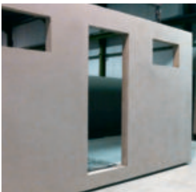
Panel prefabricado con fibra sintética estructural.
