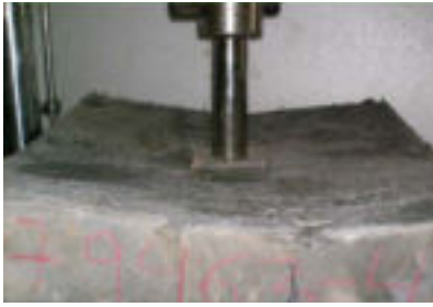
Ensayo EFNARC de punzonamiento – flexión (absorción de energía).
