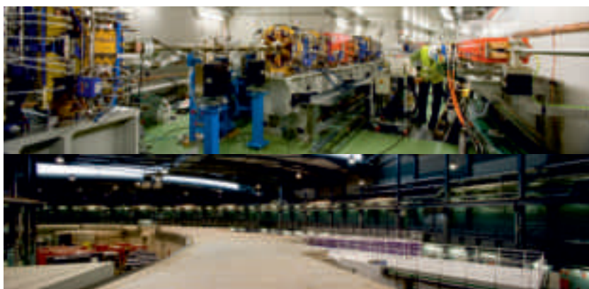
En la foto superior, la sala de onduladores. En la foto inferior, los bloques de hormigón envuelven el anillo de almacenamiento.
