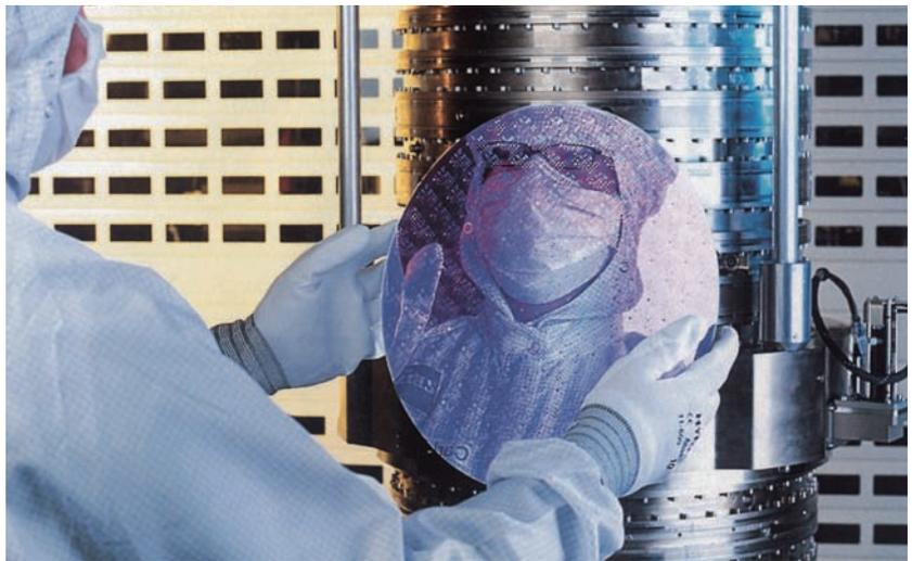
(Arriba) Láser de anhídrido carbónico de alta precisión en Triunf, Alemania. (Abajo) Grabado con láser de estructuras electrónicas de pocos nanómetros sobre oblea de silicio, para un ordenador.
