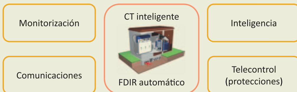
Figura 4. Funcionalidades del centro de transformación inteligente con FDIR automático
