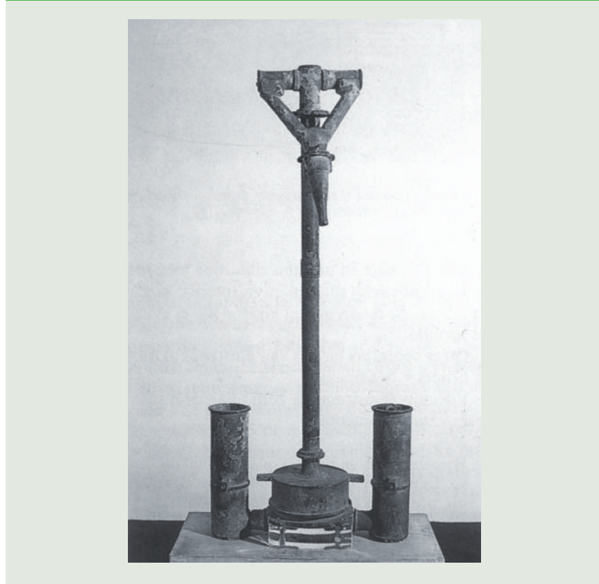
Figura 4. Bomba romana de pistones del tipo atribuido a Ctesibio. Museo Arqueológico, Madrid
