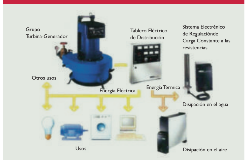
Figura 2. Esquema de componentes de instalación microhidroeléctrica
